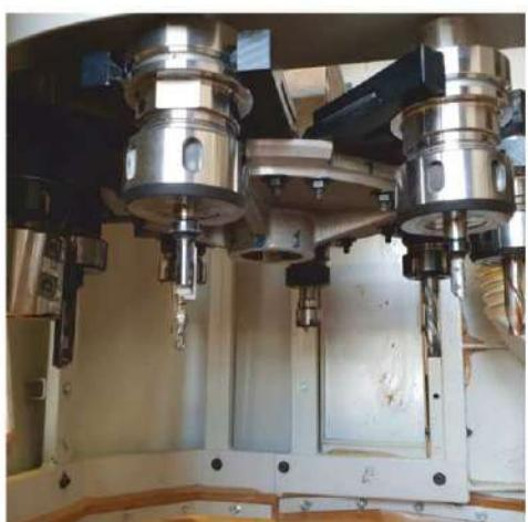
Manuel tutucu kullanıldığında saplı frezelerde gövde kırılmaları ve dış kırılmaları meydana gelmektedir. Ayrıca minimum toleranslara sahip olmadığı için rıjît kesim gerçekleştiremediğinden dolayı malzeme üzerinde pürüzlülük ve iz meydana gelmesine sebep verir. Çalışma esnasında ortalama 8 dB ses meydana gelir ve maksimum 18000 dev/dk 9-12m/dk çalışma imkânı sunar. Hidro tutucu kullanıldığında gövde kırılmaları ve dış kırılmaları meydana gelmez.
